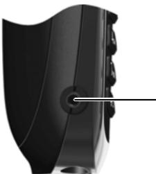
Náhlavnú súpravu je možné pripojiť pomocou 2,5 mm konektora typu jack. Podrobnejšie informácie o odporúčaných náhlavných súpravách nájdete na príslušnej produktovej stránke na adrese [www.gigaset.com](http://www.gigaset.com).
